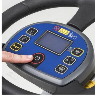
2. Reinicie el sistema sin presionar el pedal.
