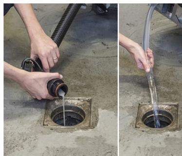
13. Vacíe el tanque de recuperación usando la manguera. Posteriormente vacíe el tanque de solución utilizando la manguera transparente.
