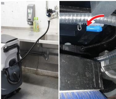
2. Llene el tanque de solución con agua limpia. La temperatura del agua no debe exceder 40° C. Asegúrate de que la válvula de solución debajo de la maquina está abierta.
