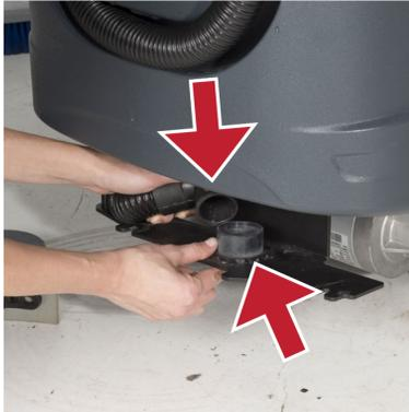
1. Verifica si la manguera de succión está correctamente instalada y sin obstrucciones.
