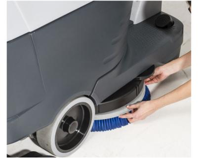
5. Coloque el cepillo o sujetador de almohadillas en la debajo del cabezal (deck). Utilice el cepillo adecuado para limpiar el piso.
