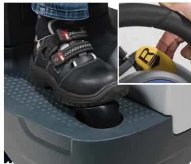
8. Presione el pedal para empezar a limpiar. Ajuste la velocidad aplicando al pedal. Para el modo de reversa presione la palanca amarilla
