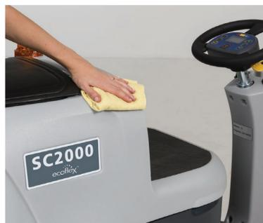
18. Limpie la máquina utilizando un trapo húmedo y, si es necesario, utiliza un químico de limpieza neutral.
