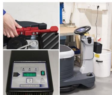
19. Cargue las baterías: conecte el cable del cargador de baterías al enchufe eléctrico de la pared.
