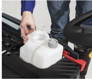
3. Llene el tanque EcoFlex™ con un detergente adecuado para máquinas de limpieza (detergente altamente concentrados y baja espuma).
